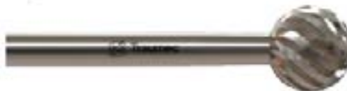
Figura 9: Broca esférica – desgaste convencional.
